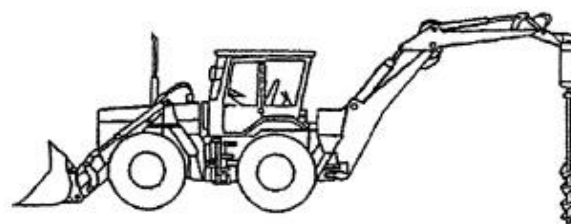
Esempio di terna con trivella
